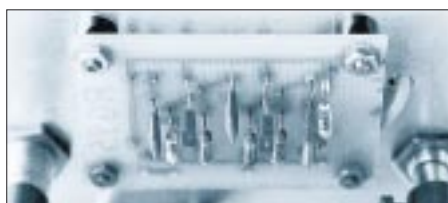
Bild 9: Blick auf die montierte Generatorplatte
