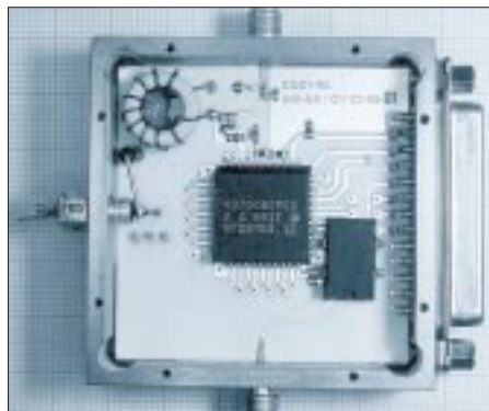
Bild 6: Der endgültige, auf in SMD-Technik realisierte Aufbau des DDS 1 (Bestückungsseite)
