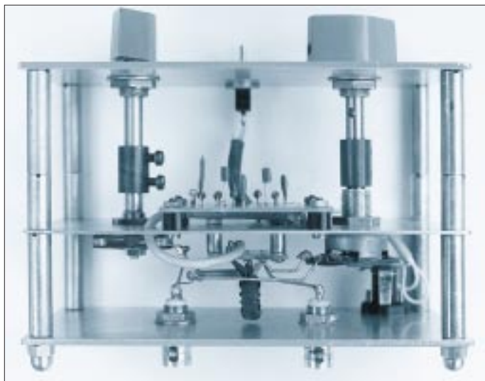
Bild 8: In der Kammer oben im Bild ist in der Mitte die Generatorleiterplatte. In der unteren Kammer von links nach rechts an der Trennwand: Drehkondensator (Quetscher), Montageplatte für den Transformator (T1 hält sich durch die sechs Anschlußdrähte seiner Wicklung selbst) und Potentiometer 250 \Omega . Die Zuführung der HF erfolgt über ein Koaxialkabel.
