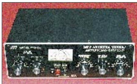
Der Antennentuner MFJ-834 verfügt als Besonderheit über eine „künstliche Erde“.
