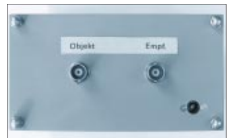
Bild 7: Rückansicht des Geräts. In der Mitte die beiden BNC-Buchsen für Meßobjekt und Empfänger, unten rechts die Betriebsspannungszuföhrung
